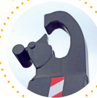
Hook with mechanical latch Crochet avec linguet par gravité
