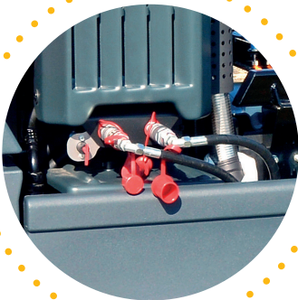
Hydraulic system connected through quick couplers Système hydraulique connecté par couplage rapide
