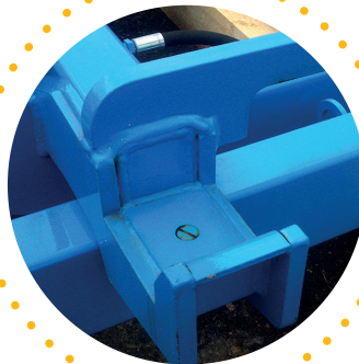
Mechanical container locking Verrouillage mécanique
